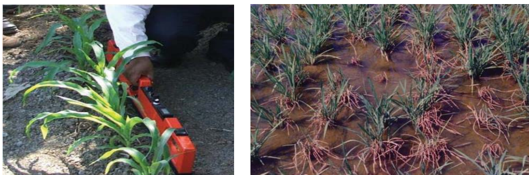
Gambar 3. Pengukuran salinitas tanah dengan EM38 (kiri) dan tanaman padi yang rusak karena salinitas air yang tinggi (kanan)
