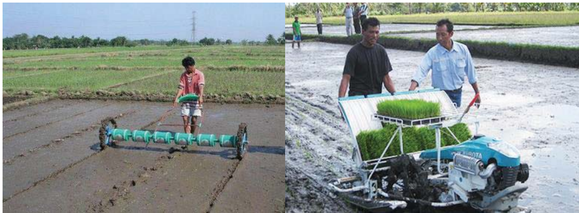
Gambar 8. Alat tanam benih langsung drum seeder (kiri) dan Indo Jarwo transplanter (kanan)
