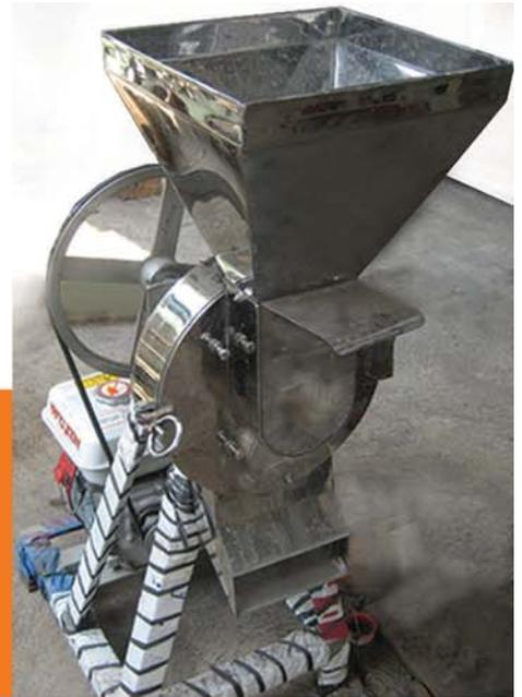
Mesin pengupas buah lada tipe piringan berfungsi melepaskan kulit buah lada dari bijinya. Mekanisme pengupasan adalah dengan menggelindingkan buah lada di antara dua piringan pengupas disertai tekanan dari karet dengan elastisitas tinggi yang dipasang pada permukaan piringan.
