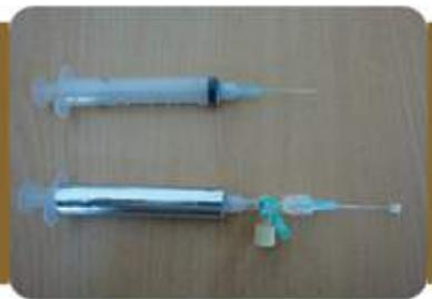
Syringe hasil invensi Balitbangtan ini telah dimodifikasi dari syringe yang ada di pasaran, yaitu dengan melakukan pelapisan atau pembungkusan pada bagian tabung dengan bahan berwarna silver dan penambahan keran diantara tabung dan jarum suntik, serta pemberian penutup berbahan karet pada ujung jarum. Syringe modifikasi ini terbuat dari plastik.
